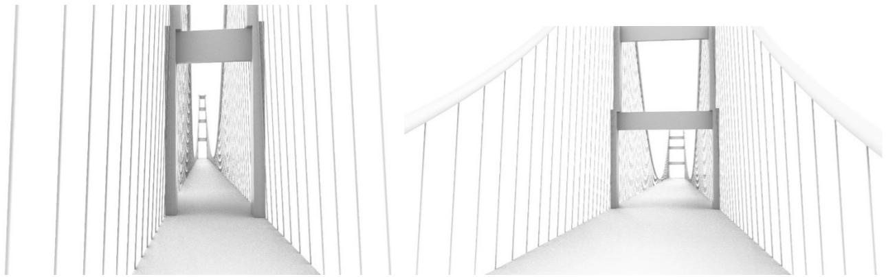
Bei der Brücke kann man die Fahrbahnbreite verstellen, so wird diese zum Beispiel breiter und die Stützen wandern mit. Da die Stützenhöhe extra verstellbar ist wandern die zwei Stützen nur auseinander, verändern sich deshalb aber nicht in der Höhe. Wenn man die Fahrbahnbreite verändert sind natürlich auch die Verstrebungen unter der Fahrbahn betroffen, so verändern diese sich mit der Fahrbahnbreite mit.
