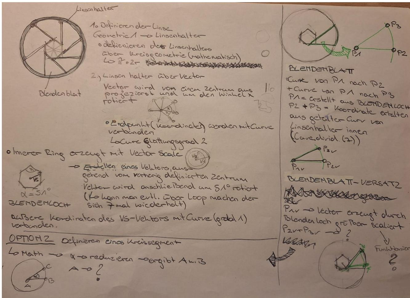
Um die Geometrie der Blende zu programmieren sollte ein Kreis in 6 Teile unterteilt werden und diese dann anschließend mit einer Curve verbunden werden. Das dadurch entstehende Sechseck sollte dann weiter unterteilt werden, die entstehende Punkte wurden anschließend mit einer Curve verbunden um das Blendenloch zu gerieren .
