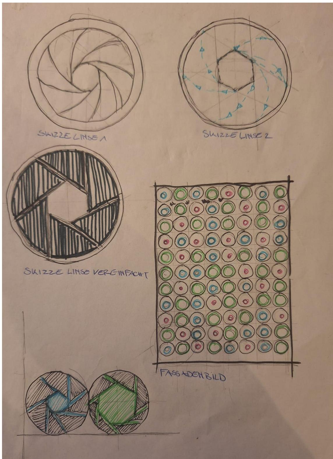
Die Grundidee war es die Geometrie einer Camarablende in die Fassade der UN Headquarters einzuarbeiten. Diese sollten sich dann aufgrund des Abstands einer sich bewegenden Bahn öffnen und schließen.
