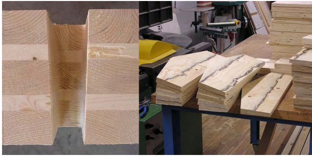
Abbildung 12: Konische Schlitz-Geometrie in den BSP-Platten (links) und die ein zu leimenden Kerto-Platten
