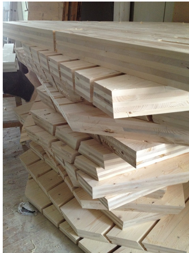
Abbildung 15: CNC-gefertigte polygonale BSP-Paneele
